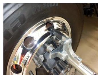
④プレートを支点にレバーを下げるとホイールがスライドします。ホイールの反対側も同様に作業してスライドさせます。
