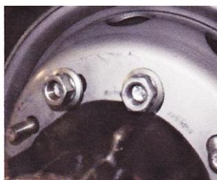
①2本のハブボルトに、ナットを装着します。車両に接触しないので、作業しやすい場所に装着して下さい。
