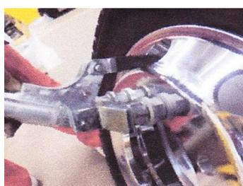
③ナット位置を調整します。ハブボルト保護のため、ハブボルトがナットより出ない様にして下さい。
