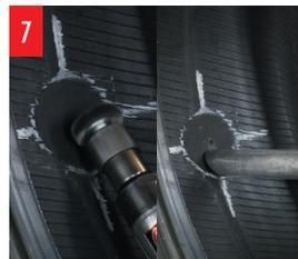
7 S-893ワイヤブラシをS-1036低速エアハフパーにセットして右から左へ軽くパフしてパフリングダスト・スチールの削り粉を取り除きます。タイヤ内に残っているダストはS-999Kエアスピックで吸い込み掃除してください。
