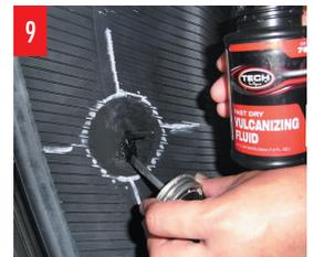
9 760ケミカルセメントを薄く塗り込むようにパフエリアに塗布します。パフエリアは越えないように注意してください。乾燥時間は3〜5分です。ドライヤー等を使用すると空気中のゴミを吹き付けてしまいますので、自然乾燥させてください。
