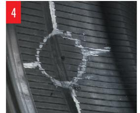
4 使用するユニシールラジアルシールより15mm程度大きめにマークします。このマークの内側をパフピングします。
