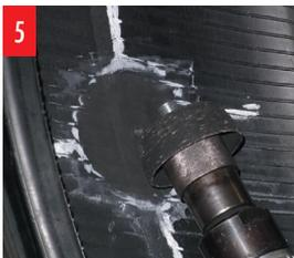
5 マーク内側をS-1036低速エアハフパーを使用しパフします。使用するエアハフパーは5000回転/分以下の物をご使用ください。
