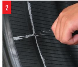
2 TRT105メジャーツールで傷穴のサイズを測定し、修理材のサイズを選定します。タイヤ内部を点検し、セパレーションやサイド部にシワがある場合は修理できません。
