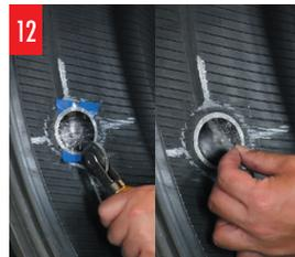
12 936ステッチャーローラーをパッチ中央部から外側に向かって掛けます。位置が決まったら残ったブルーポリを横方向に取り除き、再度中央部から外側へローラーを掛けます。透明フィルムも取り除きます。
