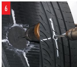
6 トラックタイヤ等スチールベルトが画いたタイヤの場合は、使用する修理材の軸径に応じたカーバイトカッターをS-1035エアドリルにセットして右回転で内側・外側の順番で最低3回以上繰り返してください。使用するエアドリルは1200回転/分以下のものをご使用ください。
