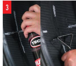
3 704Aスプレー式ハフパー液を掛け、933スクレーパーで傷穴周りの汚れやシリコンを取り除きます。これを2〜3回繰り返します。
